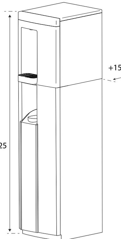
Der Wasserspender kann auf auf einen (optionalen) Unterschrank gestellt werden. Der Unterschrank enthält CO<sub>2</sub>-Behälter, Wasserfilter und Abwassertank. Die erforderlichen Strom- und Wasseranschlüsse befinden sich an der Rückwand oder im Unterschrank.
