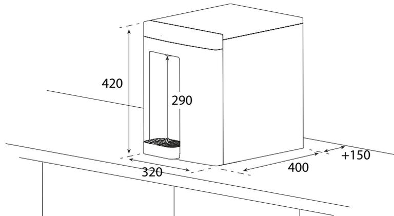
Der CO<sub>2</sub>-Behälter und der Wasserfilter werden im Unterschrank untergebracht. Die erforderlichen Strom- und Wasseranschlüsse befinden sich an der Rückwand oder im Unterschrank.
